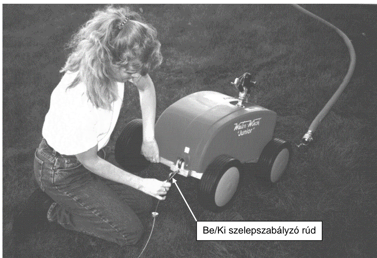
10. ábra: A gép téliesítése.
